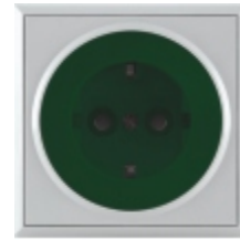
Dvopolna priklju nica sa zaštitnim elementom, zelena IEC 60884-1, CEE7 16A/250V; IP 20
